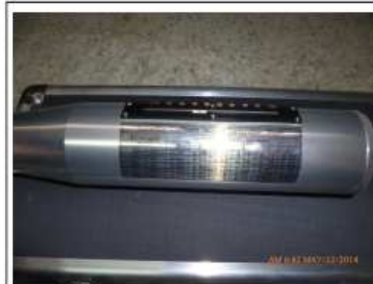
Foto 4: Resultados con una aproximación del 15% en hormigón de 1.280 a 8.500 PSI
