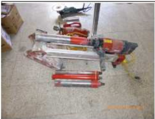
Foto 1: Extractor de núcleos marca HILTI ref. DD130 tres velocidades para brocas diamantadas de 4" a 1"
