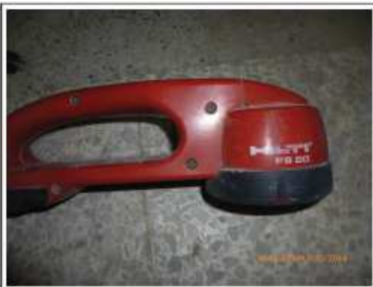
Foto 6: Ferroskan HILTI PS 20 digital para localización de barras refuerzo profundidad 30 a 40 mm
